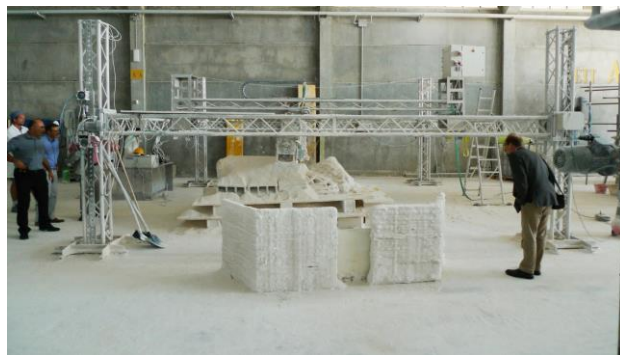
Figura 1: Sistema cartesiano de construcción impresa (D-shape, 2020).
