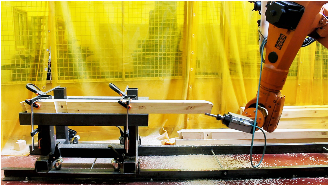
Fig. 2 Robot workcell (KUKA KR125/2 and 4.5KW HSD spindle)
