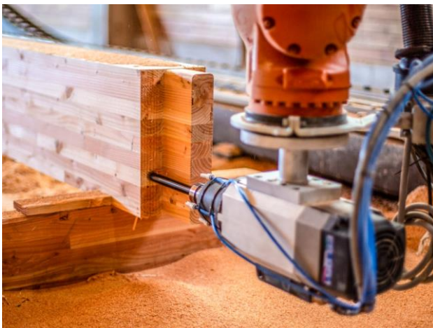
Figura 5: Mecanizado de espiga en viga de madera laminada de pino Oregon.
